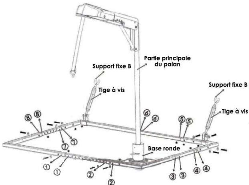
1/ Raccordez chaque tube selon le même numéro, et assemblez-le en référence au chiffre sans les visser. Passez les supports fixe B (supports Isofix) dans les tubes se trouvant au fond du coffre
