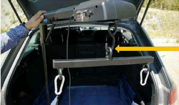
Si nécessaire, placez le palan fourni avec votre ERGO ATLAS sur le crochet pour une meilleure répartition de la charge (voir photo ci-dessus)
