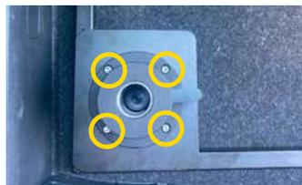
5/ Réglez le support fixe B sur l'attache ISOFIX derrière le dossier de la banquette arrière côté droit, faites pivoter la tige de vis et verrouillez fermement le support.
