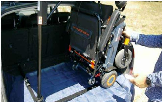
Appuyez et maintenez enfoncé le bouton B (bouton bas) pour abaisser le palan jusqu'à ce que le fauteuil ou le scooter soit positionné à l'intérieur du coffre
