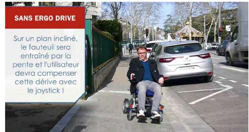
Le module de puissance interprète la vitesse de chaque roue et analyse en temps réel si celle-ci est conforme aux informations données par l'utilisateur via le joystick. Si la vitesse réelle de la roue n'est pas la bonne (parce que sur une surface accrocheuse par exemple), le module de puissance va la modifier conformément aux informations du joystick.
