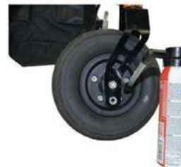
Cet accessoire permet de regonfler un pneu du fauteuil en cas de crevaison, pour une distance d'environ 3 km, avant de procéder aux réparations nécessaires.
